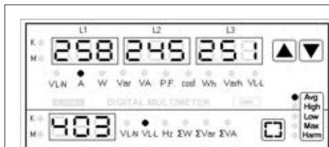
Esempio (con average inserito) Example (with average enabled) Exemple (avec moyenne activée) Ejemplo (con promedio activado) L1=258A, L2=245A, L3=251A 403VL-L
